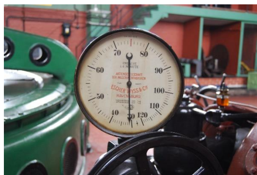
Fot. 2. Przyrząd pomiarowy – obrotomierz, producenta turbin Escher Wyss und Co. z Ravensburga z 1924 roku. Fot. P. Gerber 2013
